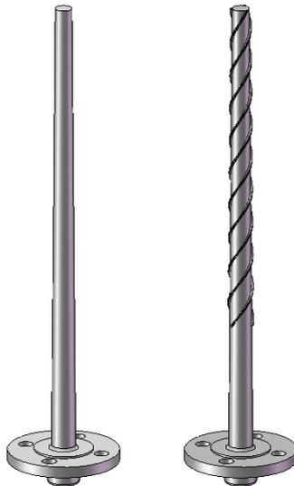
*Figure 1 – Thermowell CAD Models*
